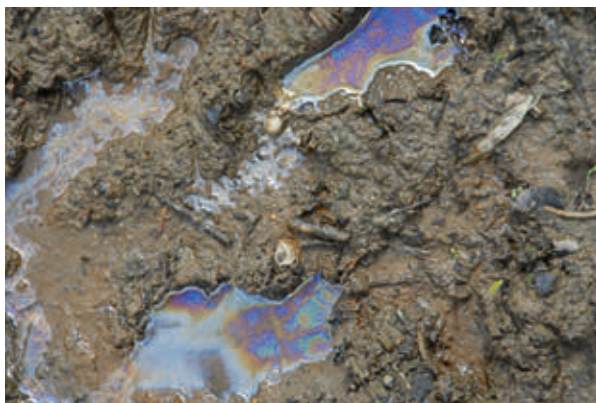
Ölverschmutzung durch ausgelaufenes Heizöl
