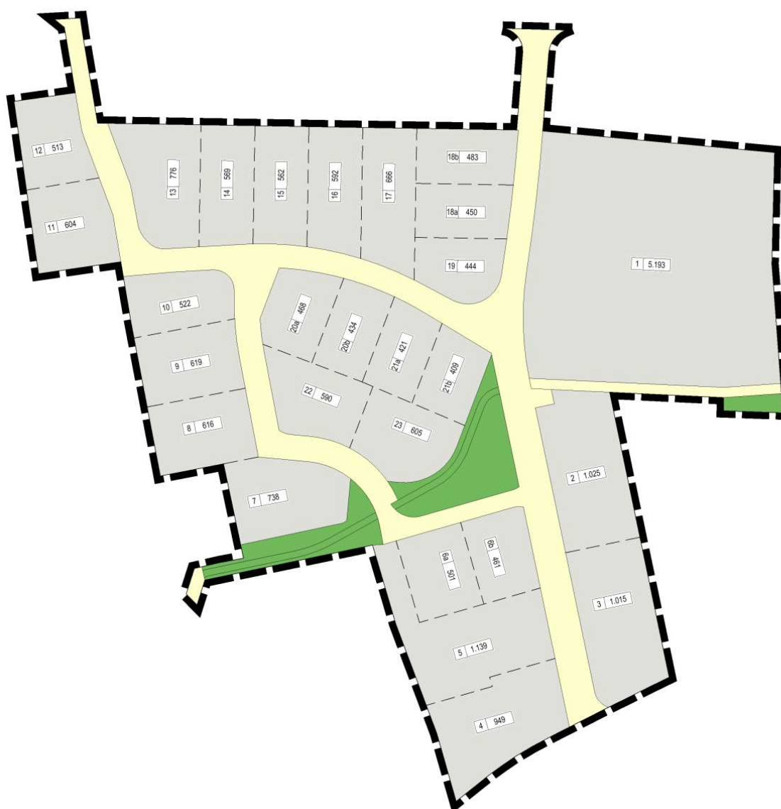
Abb. 11: Lageplan vorgeschlagene Parzellierung mit Grundstücksgößen
